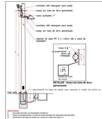
DETALHE 2a - instalação Postes PL04 a PL06 sem escala
