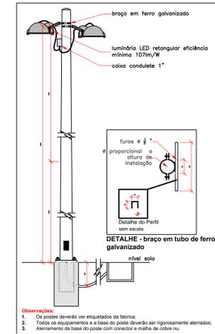
DETALHE 1a - instalação Postes PL01 a PL03 sem escala
