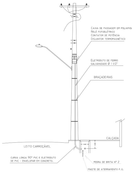
**DETALHE PONTO DE MEDIÇÃO SEM ESCALA**
